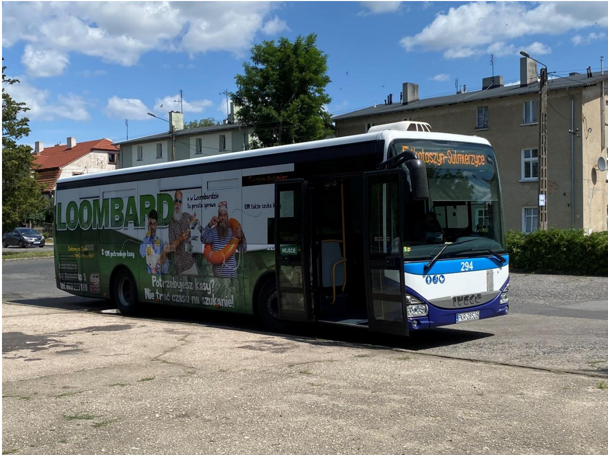
Rys. 4.3 Częściowo niskopodłogowy autobus typu MAXI.
